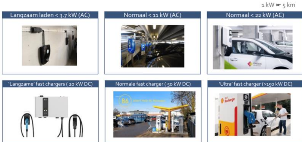
Figuur 3: Soorten laadpalen en bijbehorende vermogens
